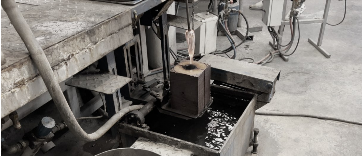
16. ábra: az olvadt üveg bükkfa sablonba vezetése [48]
