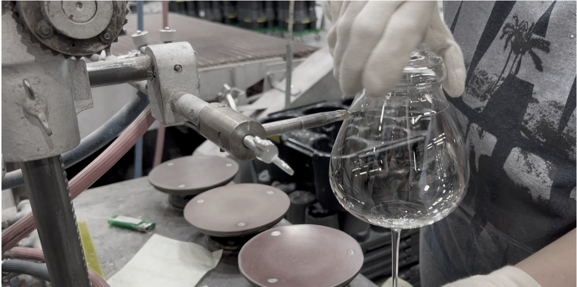
22. ábra: a kehely felső részének levágása [58]
