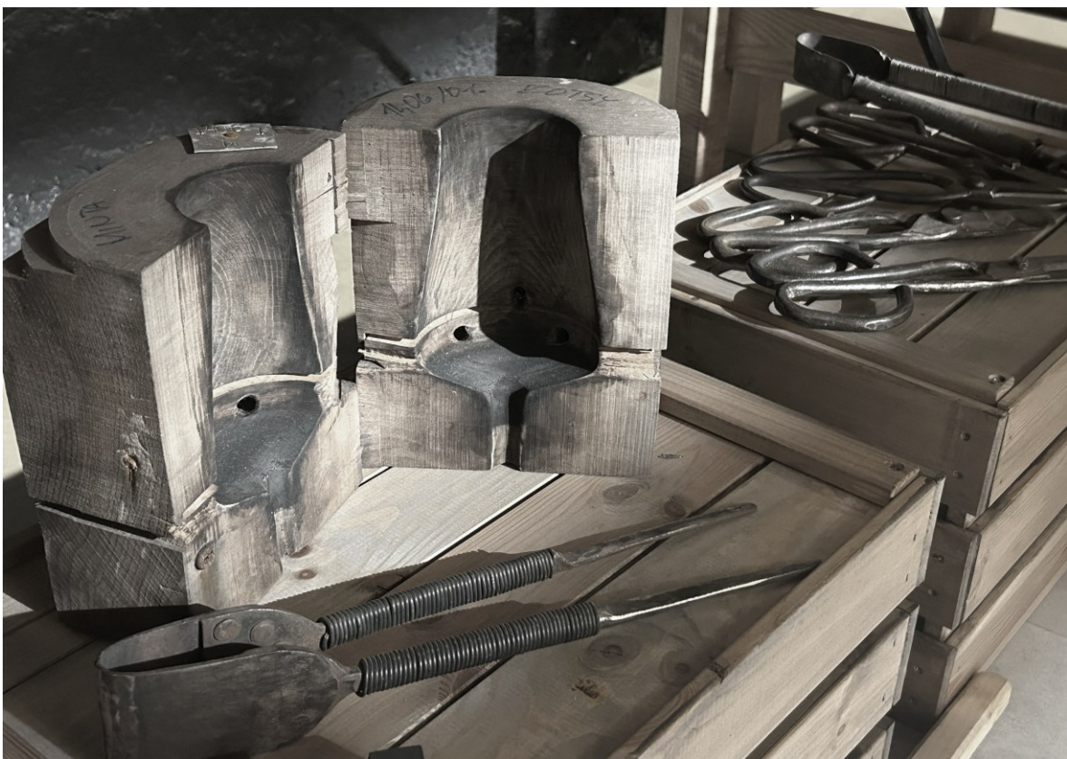
9. ábra: bükkfából készült kehelysablón [33]
