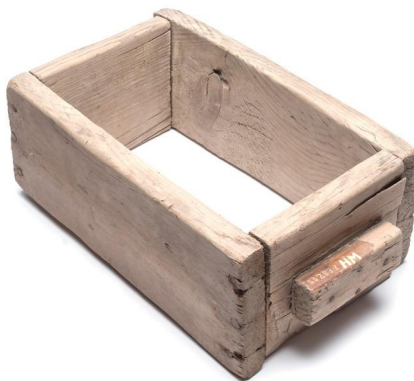
8. Kép: Vályogvető forma [14]
