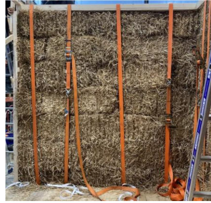
5. ábra, 6. ábra- Önhordó szalmafalak előnyomása [25.]
