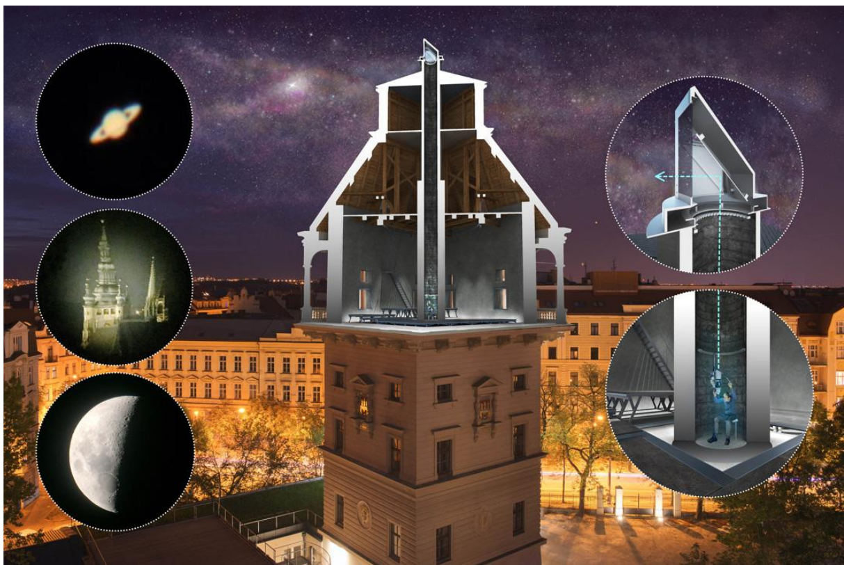
Koncepcióábra, toronyban kialakított távcső
